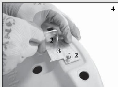
**IT** Con una chiave esagonale, montare l'elemento 3 come in figura, utilizzando le viti 2.
