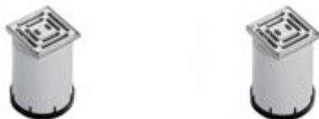
**Résumé** Élément de rehausse avec tube en polypropylène Ø11 cm, cadre inox 10x10 cm + grille en inox 9x9 cm. Pour corps d'avaloir de sol 40, 42 et 46 et avaloirs de balcon et de terrasse 83 et 84 de Dallmer.
