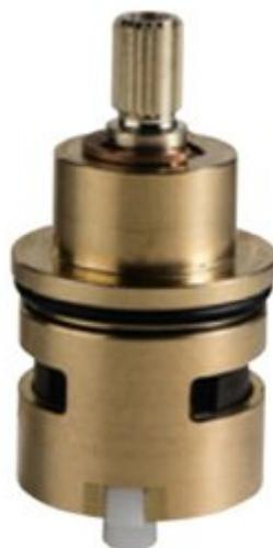
**Résumé** Pièce détachée TREEMME : Cartouche d'inversion 2 voies avec cran d'arrêt pour thermostatiques de douche muraux en applique (ref RTVT172).
