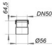
**Résumé** Manchon pour raccordement des tuyaux DN 50 avec des tuyaux en PVC 2" selon le standard britannique BS EN 1455.
